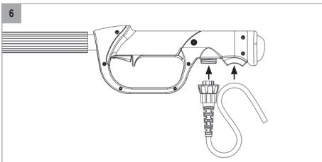
6. Sluit de kabelaansluiting van de verlengstok aan (6) en vorm een lus met de kabel in het bevestigingssysteem van de kabel (7).
