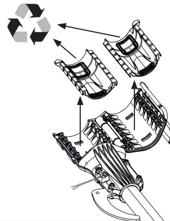
A. Należy otworzyć system mocowania narzędzia (1) i wyjąć z niego wkłady (11). Zużyte wkłady nadają się do recyklingu.
