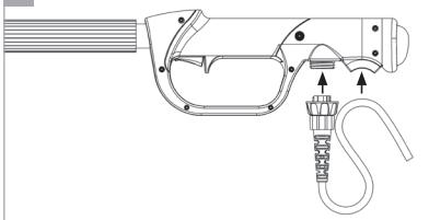
6. Conecte la clavija del cable del conector de la púrtiga (6) y forme un bucle con el cable en el dispositivo de fijación del cable (7).
