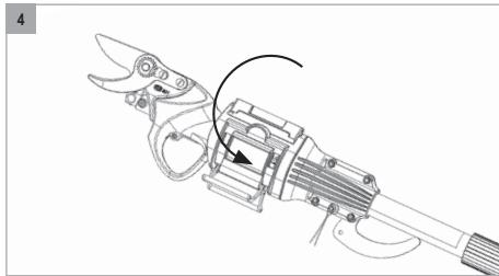
4. Schliessen Sie an der elektrischen Baum- und Rebschere (FELCO 802, FELCO 802G, FELCO 812 oder FELCO 822) das Werkzeugbefestigungssystem (1).
