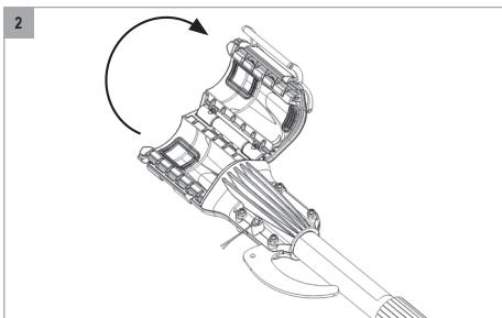
2. Uzmite dršku FELCO 880/100-100 i/ili FELCO 880/100-150 te otvorite ručku za zatvaranje sustava za pričvršćivanje alata (8) (FELCO 802, FELCO 802G, FELCO 812 ili FELCO 822).
