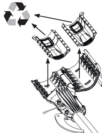
A. Öffnen Sie das Werkzeugbefestigungssystem (1) und entfernen Sie die Einsätze (11) aus dem Werkzeugbefestigungssystem (1). Entsorgen Sie die alten Teile in einer Wertstoffannahmestelle.
