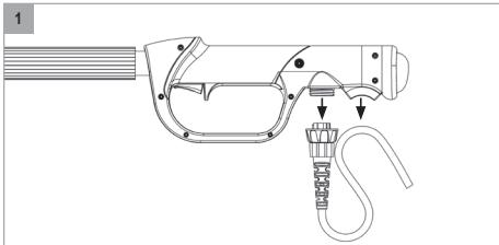
1. Provjerite je kabel odspojen s priključka koji se nalazi na drški FELCO 880/100-100 i/ili FELCO 880/100-150.
