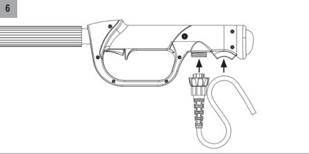
6. 将电缆插头连接至延长杆连接器（6）并在电缆固定装置（7）中打一个圈。
