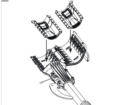
B. Nowe wkłady (11) należy umieścić w odpowiednim kierunku w obu częściach systemu mocowania narzędzia (1).
