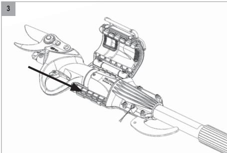
3. Sluit de elektrische snoeischaar aan (FELCO 802, FELCO 802G, FELCO 812 of FELCO 822) tot deze tegen de aanslag van het bevestigingssysteem van het gereedschap (1) komt
