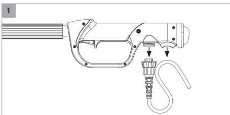
1. Kablo konnektörünün FELCO 880/100-100 ve/veya FELCO 880/100-150 uzatma borusu ile bağlantısının kesildiğinden emin olun.
