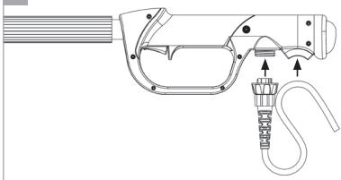
6. Ligue o conector do cabo da extensão (6) e forme um laço com o cabo no dispositivo de fixação do cabo (7).
