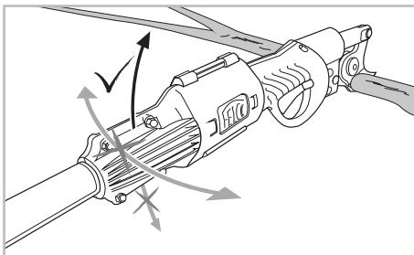
Desconecte del conector de la púrtiga 6 la podadera electroportátil y el conector del cable durante el almacenamiento de la púrtiga FELCO 880/100-100 o FELCO 880/100-150.
