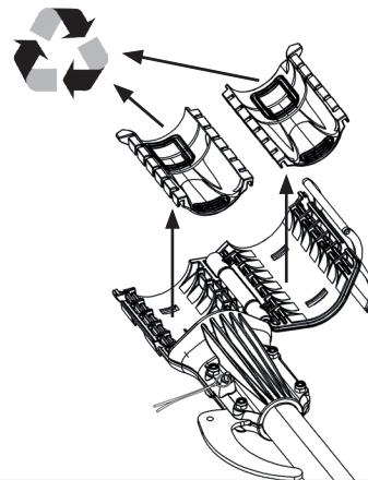
A. Abra o sistema de fixação da ferramenta (1) e retire os encaixes (11) fazendo-os sair do sistema de fixação da ferramenta (1). Coloque as peças usadas na reciclagem.
