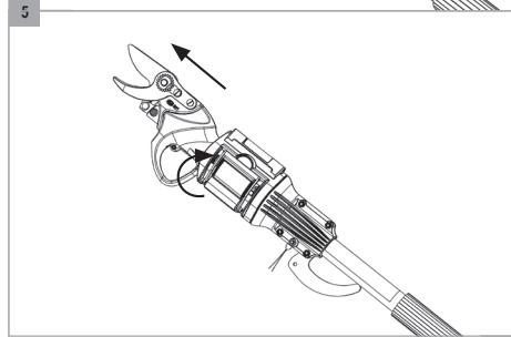
5. Закройте запорный рычаг системы крепления (8), который должен зафиксироваться на противоположной части системы крепления. Зашелкните рычаг системы крепления. Убедитесь, что запорный рычаг системы крепления (8) надежно защелкнут. Ни один элемент запорного рычага системы крепления (8) не должен свободно двигаться в процессе использования удлинительной штанги.
