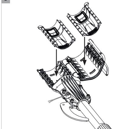
B. Neem de nieuwe inserts (11) en zet ze op de twee delen van het bevestigingssysteem van de snoeischaar (1) vast en plaats ze correct.
