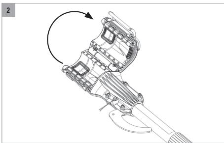
2. Nehmen Sie die Verlängerungsstange FELCO 880/100-100 bzw. FELCO 880/100-150 und öffnen Sie den Verschlusshebel des Werkzeugbefestigungssystems (8) (FELCO 802, FELCO 802G, FELCO 812 oder FELCO 822).
