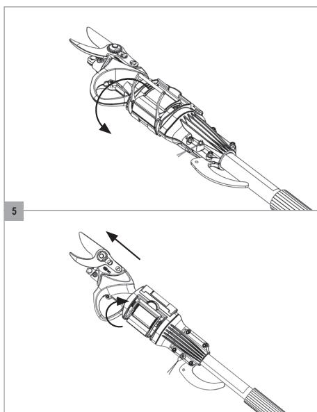
5. Cierre la palanca de cierre del sistema de fijación (8) que debe fijarse en el estuche opuesto. Bloquee el sistema de fijación bloqueándolo contra el estuche. Asegúrese de que la palanca de cierre del sistema de fijación (8) esté bien bloqueada. Ninguna pieza de la palanca de cierre del sistema de fijación (8) debe moverse libremente mientras la pértega esté en uso.
