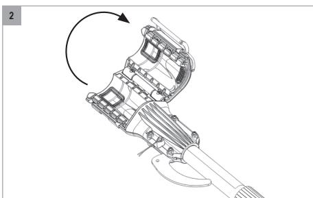
2. Segure na extensão FELCO 880/100-100 e/ou FELCO 880/100-150 e abra a alavanca de fecho do sistema de fixação (8) da ferramenta (FELCO 802, FELCO 802G, FELCO 812 ou FELCO 822).
