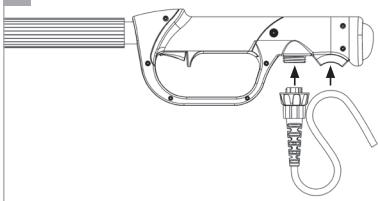
6. Connectez le connecteur câble du connecteur de la perche (6) et formez une boucle avec le câble dans le dispositif de fixation du câble (7).
