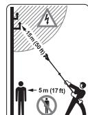
Μην χρησιμοποιείτε το κοντάρι FELCO 880/100-100 ή/και FELCO 880/100-150 σε απόσταση μικρότερη των 5 μέτρων (17 ft) από άλλον χρήστη.
