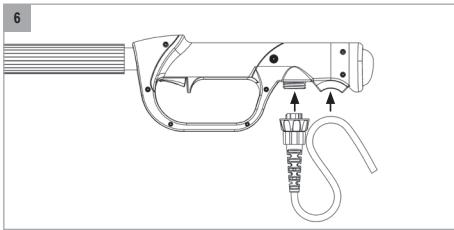
6. Συνδέστε το βύσμα του καλωδίου στην υποδοχή του κονταριού (6) και δημιουργήστε έναν βρόχο με το καλώδιο στη διάταξη στερέωσης του καλωδίου (7).
