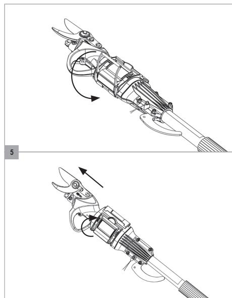
5. Κλείστε τον μοχλό κλεισίματος του συστήματος στερέωσης (8), ο οποίος πρέπει να ασφαλίζει στην αντίθετη υποδοχή. Κλειδώστε το σύστημα στερέωσης ασφαλίζοντάς το στην υποδοχή. Βεβαιωθείτε ότι ο μοχλός κλεισίματος του συστήματος στερέωσης (8) είναι κλειδωμένος. Κανένα τμήμα του μοχλού κλεισίματος του συστήματος στερέωσης (8) δεν πρέπει να κινείται ελεύθερα όταν χρησιμοποιείται το κοντάρι.
