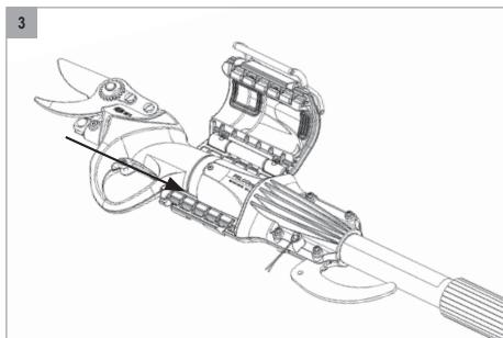
3. 安装电动修枝剪（FELCO 802、FELCO 802G、FELCO 812或FELCO 822）直至接触到工具固定系统（1）底端，调整好方向。
