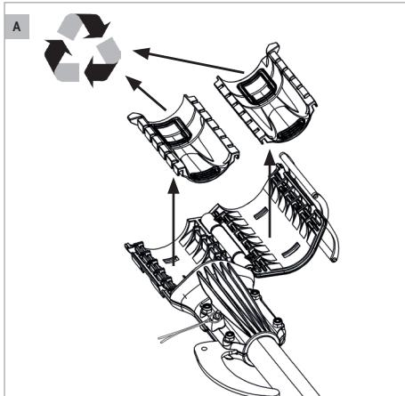
A. 打开工具固定系统（1），拆下垫片（11），将其从工具固定系统（1）中取出。旧垫片应被回收。
