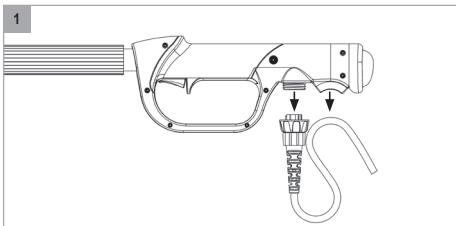
1. Certifique-se de que o conector do cabo está corretamente desligado da extensão FELCO 880/100-100 e/ou FELCO 880/100-150.
