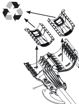
A. Alet sabitleme sistemini (1) açın ve alet sabitleme sisteminden (1) çıkarmak için eklemleri (11) çıkarın. Eski parçaları geri dönüşüm noktalarına atın.
