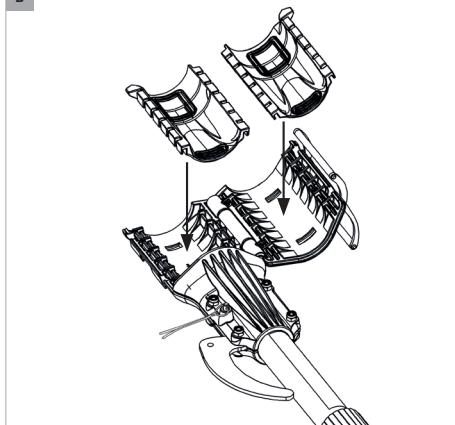
Б. Возьмите новые вставки (11) и закрепите их на двух сторонах системы крепления инструмента (1), правильно развернув их.
