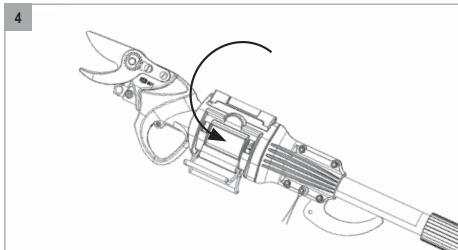
4. Następnie należy zamknąć system mocowania narzędzi (1) na sekatorze elektrycznym (FELCO 802, FELCO 802G, FELCO 812 lub FELCO 822).
