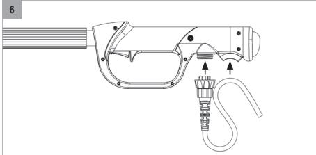
6. Uzatma borusu konnektörünün bağlantı kablosunu (6) bağlayın ve kablo sabitleme düzeneğinde (7) kablo ile bir halka oluşturun.
