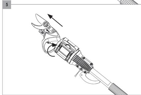
5. Sluit de vergrendelingshendel van het bevestigingssysteem (8), die vast moet zitten in de tegenoverliggende schelp. Vergrendel het bevestigingssysteem door het tegen de schelp te vergrendelen. Controleer of de hendel van het bevestigingssysteem (8) goed vergrendeld is. Er mogen geen onderdelen van de vergrendelingshendel van het bevestigingssysteem (8) vrij bewegen wanneer de verlengstok gebruikt wordt.
