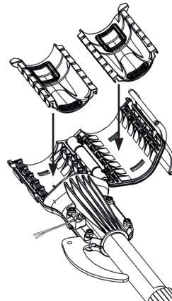
B. Tome los nuevos insertos (11) y fíjelos en ambas partes del sistema de fijación de la herramienta (1) orientándolos de forma correcta.
