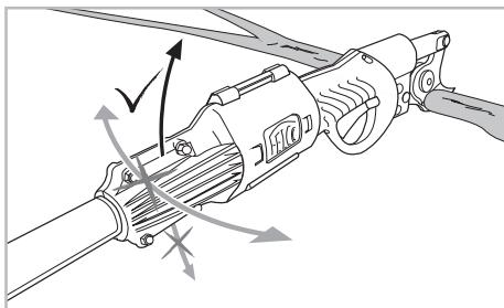
W trakcie przechowywania wisiernika FELCO 880/100-100 i/lub FELCO 880/100-150 należy odłączyć sekator elektryczny i łącznik kabla wisiernika (6).
