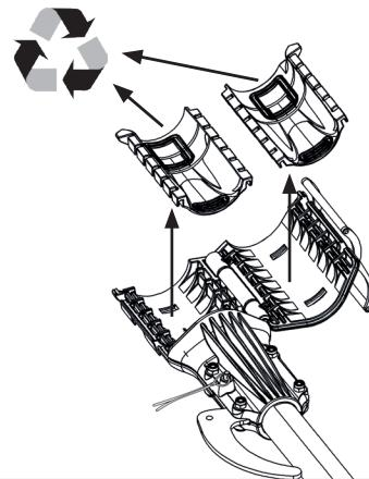
A. Ανοίξτε το σύστημα στερέωσης του εργαλείου (1) και αφαιρέστε τα παρεμβλήματα (11) για να τα απομακρύνετε από το σύστημα στερέωσης του εργαλείου (1). Απορρίψτε τα χρησιμοποιημένα μέρη στην ανακύκλωση.
