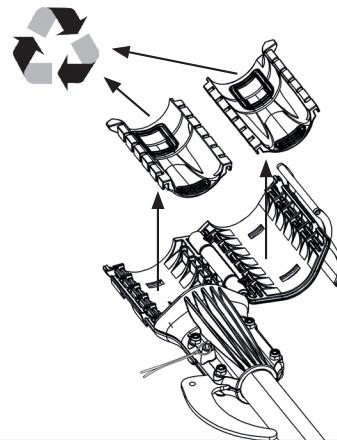
А. Откройте систему крепления инструмента (1) и выньте вставки (11), чтобы их извлечь из системы крепления инструмента (1). Отработавшие детали подлежат утилизации.
