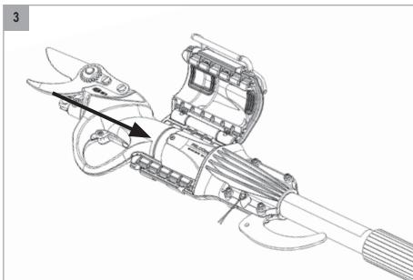
3. Stecken Sie die elektrische Baum- und Rebschere (FELCO 802, FELCO 802G, FELCO 812 oder FELCO 822) korrekt positioniert bis zum Anschlag in das Werkzeugbefestigungssystem (1) ein.
