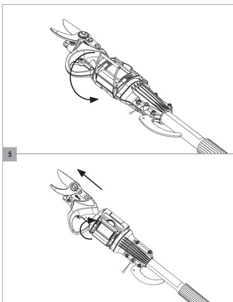
5. 关闭固定系统关闭开关（8），该开关应卡入另半边固定壳中。锁闭固定系统。确认固定系统关闭开关（8）已锁好。使用延长杆时固定系统关闭开关（8）的任何部件均不应出现移动。
