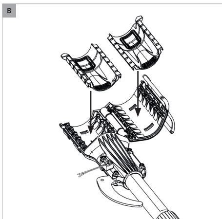
B. 将新垫片（11）固定在工具固定系统（1）的两边，调整好方向。
