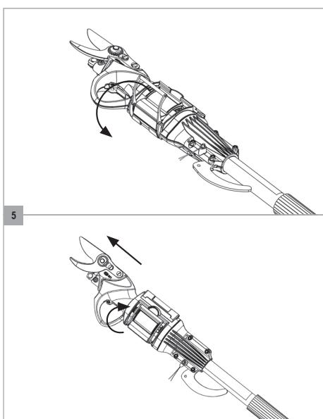
5. Feche a alavanca de fecho do sistema de fixação (8), que deve ser fixada na cobertura oposta. Bloqueie o sistema de fixação bloqueando-o contra a cobertura. Certifique-se de que a alavanca de fecho do sistema de fixação (8) está devidamente bloqueada. Nenhuma peça da alavanca de fecho do sistema de fixação (8) deve mexer livremente quando a tesoura e extensor são utilizadas.
