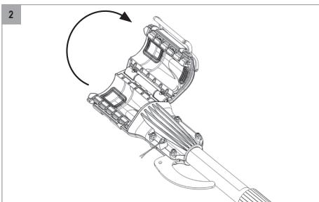
2. W wyciągniku FELCO 880/100-100 i/lub FELCO 880/100-150 należy otworzyć dźwignię zamykania systemu mocowania (8) narzędzi (FELCO 802, FELCO 802G, FELCO 812 lub FELCO 822).
