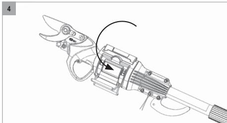
4. Chiudere il sistema di fissaggio dell'utensile (1) sulla forbice eletroportatile (FELCO 802, FELCO 802G, FELCO 812 o FELCO 822).
