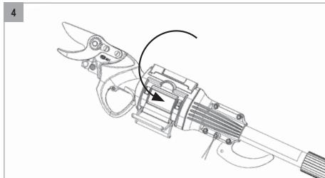
4. Cierre el sistema de fijación de la herramienta (1) en la podadera electroportátil (FELCO 802, FELCO 802G, FELCO 812 o FELCO 822).
