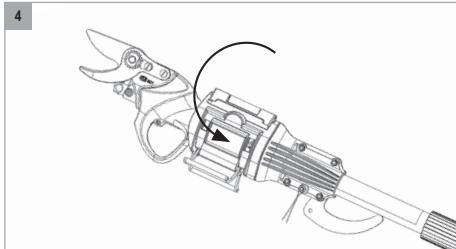
4. Sluit het bevestigingssysteem (1) op de elektrische snoeischaar (FELCO 802, FELCO 802G, FELCO 812 of FELCO 822).
