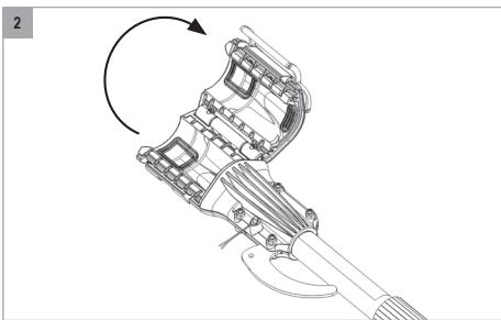
2. Возьмите удлинительную штангу FELCO 880/100-100 и/или FELCO 880/100-150 и откройте запорный рычаг системы крепления (8) инструмента (FELCO 802, FELCO 802G, FELCO 812 или FELCO 822).
