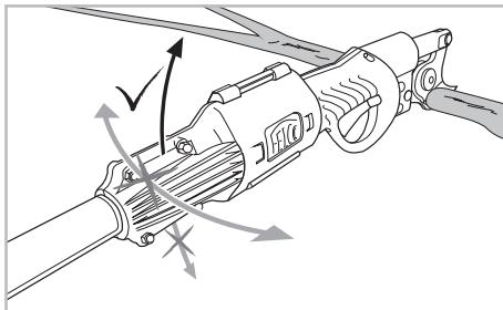
Desligue a tesoura de poda elétrica e o conector do cabo da extensão 6 aquando do armazenamento da extensão FELCO 880/100-100 e/ou FELCO 880/100-150.
