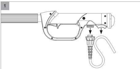
1. Controleer of de aansluiting van de kabel goed losgekoppeld is van de verlengstok FELCO 880/100-100 en/of FELCO 880/100-150.
