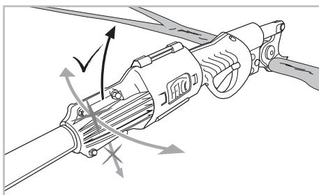
Odspojite prijenosne električne škare i spojni kabel s priključka na drški (6) tijekom pohranjivanja drške FELCO 880/100-100 i/ili FELCO 880/100-150.
