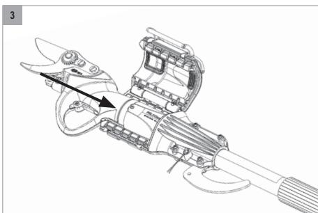
3. Ligue a tesoura de poda elétrica (FELCO 802, FELCO 802G, FELCO 812 ou FELCO 822) até bloquear no fundo do sistema de fixação da ferramenta (1), orientando-a corretamente.
