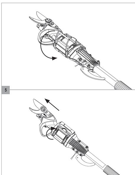
5. Należy zamknąć dźwignię zamykania systemu mocowania (8), który musi się zatrzasnąć po drugiej stronie. System mocowania należy zablokować, dobrze go zaciskając. Należy sprawdzić, czy dźwignia zamykania systemu mocowania (8) jest dobrze zablokowana. Żaden element dźwigni zamykania systemu mocowania (8) nie może się ruszać, kiedy wyciągik jest w użyciu.
