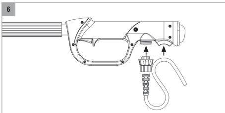
6. Подсоедините штепельный разъем кабеля к разъему удлинительной штанги (6) и создайте контур с кабелем в устройстве крепления кабеля (7).
