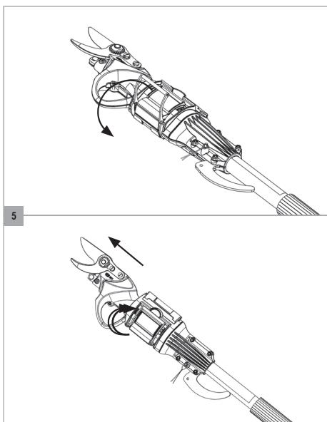
5. Chiudere la leva di chiusura del sistema di fissaggio (8), che si deve fissare nel coperchio opposto. Bloccare il sistema di fissaggio, bloccandolo contro il coperchio. Accertarsi che la leva di chiusura del sistema di fissaggio (8) sia bloccata correttamente. Nessun pezzo della leva di chiusura del sistema di fissaggio (8) deve muoversi liberamente quando si utilizza la prolunga.
