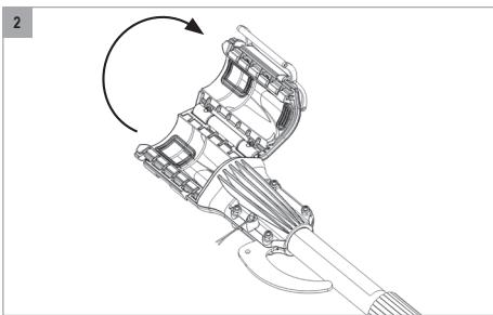
2. Neem de verlengstok FELCO 880/100-100 en/of FELCO 880/100-150 en open de sluithendel van het bevestigingssysteem (8) voor de snoeischaar (FELCO 802, FELCO 802G, FELCO 812 of FELCO 822).
