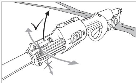
De elektrische snoeischaar en de aansluitkabel van de verlengstok (6) loskoppelen tijdens de opslag van de verlengstok FELCO 880/100-100 en/of FELCO 880/100-150.
