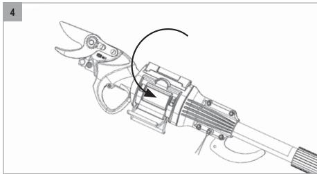
4. 将安装好电动修枝剪（FELCO 802、FELCO 802G、FELCO 812或FELCO 822）的工具固定系统（1）关闭。
