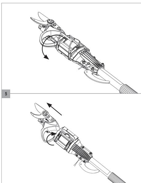
5. Fermez le levier de fermeture du système de fixation (8), qui doit se fixer dans la coque opposée. Verrouillez le système de fixation en le verrouillant contre la coque. Assurez-vous que le levier de fermeture du système de fixation (8) est bien verrouillé. Aucune pièce du levier de fermeture du système de fixation (8) ne doit bouger librement lorsque la perche est utilisée.
