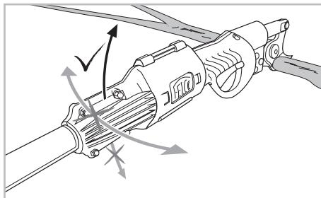
Bei der Lagerung der Verlängerungsstange FELCO 880/100-100 bzw. FELCO 880/100-150 ist die elektrische Baum- und Rebschere und der Kabelstecker (6) von der Stange abzutrennen.
