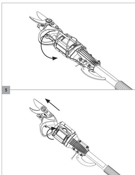
5. Zatvorite ručku za zatvaranje sustava za pričvršćivanje (8) koja mora ulegnuti u suprotni utor. Gurnite sustav za pričvršćivanje prema utoru kako biste ga zaključali. Provjerite je li ručka za zatvaranje sustava za pričvršćivanje (8) dobro zaključana. Nijedan dio ručke za zatvaranje sustava za pričvršćivanje (8) ne smije se slobodno kretati tijekom uporabe drške.
