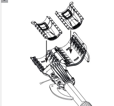
B. Uzmite nove umetke (11), pravilno ih postavite i učvrstite ih na dva dijela sustava za pričvršćivanje alata (1).
