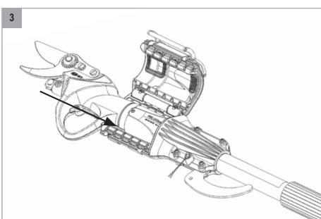
3. Sekator elektryczny (FELCO 802, FELCO 802G, FELCO 812 lub FELCO 822) należy włożyć aż do oporu w systemie mocowania narzędzia (1) z zachowaniem odpowiedniego kierunku.
