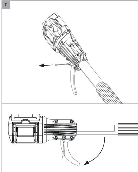
7. Kesimden sonra düşmeyen bir dalı tutmak için, bu amaç için tasarlanmış çengeli (10) kullanabilirsiniz.
