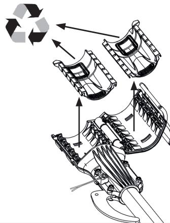
A. Otvorite sustav za pričvršćivanje alata (1) i povucite umetke (11) kako biste ih izvukli iz sustava za pričvršćivanje alata (1). Odložite stare umetke za recikliranje.
