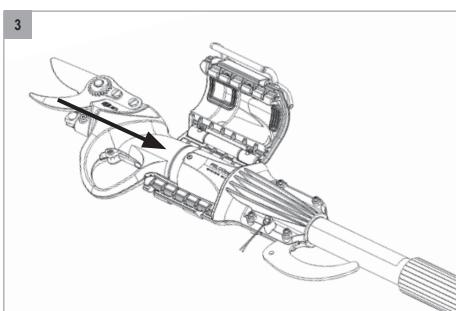
3. Collegare la forbice eletroportatile (FELCO 802, FELCO 802G, FELCO 812 o FELCO 822) fino a che non sia in arresto sul fondo del sistema di fissaggio dell'utensile (1), orientandola correttamente.
