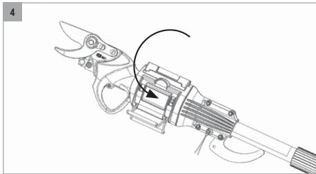
4. Fermez le système de fixation de l'outil (1) sur le sécateur électroportatif (FELCO 802, FELCO 802G, FELCO 812 ou FELCO 822).
