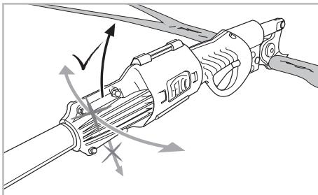
FELCO 880/100-100 ve/veya FELCO 880/100-150 uzatma borusunun depolanması sırasında, elektronik taşınamaz budama makası ve uzatma borusu (6) konnektörünün bağlantı kablosunun bağlantısını birbirinden ayırin.
