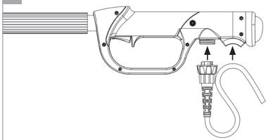
6. Należy podłączyć kabel do wysięgnika (6) i uformować pętlę z kabla w miejscu mocowania kabla (7).
