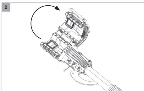
2. 手持FELCO 880/100-100和/或FELCO 880/100-150延长杆，打工具（FELCO 802、FELCO 802G、FELCO 812或FELCO 822）固定系统关闭开关（8）。
