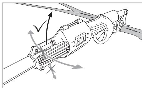
Отсоединяйте портативный электрический секатор и штекерный разъем кабеля от разъема удлинительной штанги 6 при хранении удлинительной штанги FELCO 880/100-100 и/или FELCO 880/100-150.
