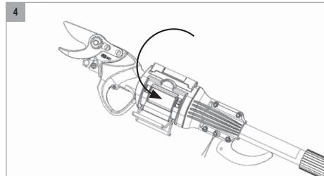
4. Κλείστε το σύστημα στερέωσης του εργαλείου (1) γύρω από το ηλεκτρικό φορητό ψαλίδι κλαδέματος (FELCO 802, FELCO 802G, FELCO 812 ή FELCO 822).
