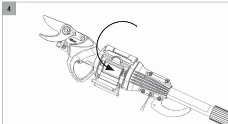
4. Feche o sistema de fixação da ferramenta (1) na tesoura de poda elétrica (FELCO 802, FELCO 802G, FELCO 812 ou FELCO 822).
