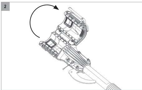
2. Tome la pértega FELCO 880/100-100 o FELCO 880/100-150 y abra la palanca de cierre del sistema de fijación (8) de la herramienta (FELCO 802, FELCO 802G, FELCO 812 o FELCO 822).
