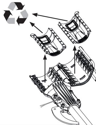
A. Open het bevestigingssysteem van de snoeischaar (1) en trek de inserts (11) naar achter om ze uit het bevestigingssysteem van de snoeischaar (1) te halen. Breng de oude onderdelen naar het containerpark.
