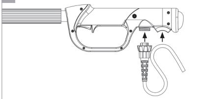
6. Schliessen Sie den Kabelstecker des Stangenanschlusses (6) an und bilden Sie mit dem Kabel im Kabelbefestigungssystem (7) eine Schlaufe.
