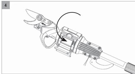
4. Zatvorite sustav za pričvršćivanje alata (1) na prijenosnim električnim škarama (FELCO 802, FELCO 802G, FELCO 812 ili FELCO 822).
