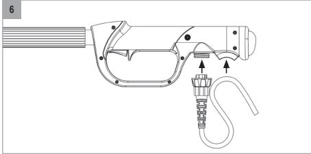
6. Collegare il connettore del cavo del connettore della prolunga (6) e formare un occhiello con il cavo nel dispositivo di fissaggio del cavo (7).
