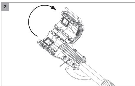
2. Κρατήστε το κοντάρι FELCO 880/100-100 ή/και FELCO 880/100-150 και ανοίξτε τον μοχλό κλεισίματος του συστήματος στερέωσης (8) του εργαλείου (FELCO 802, FELCO 802G, FELCO 812 ή FELCO 822).
