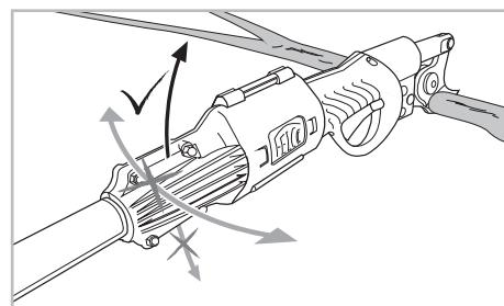
存放FELCO 880/100-100和/或FELCO 880/100-150延长杆时需取下电动修枝剪和断开延长杆电缆连接器（6）。
