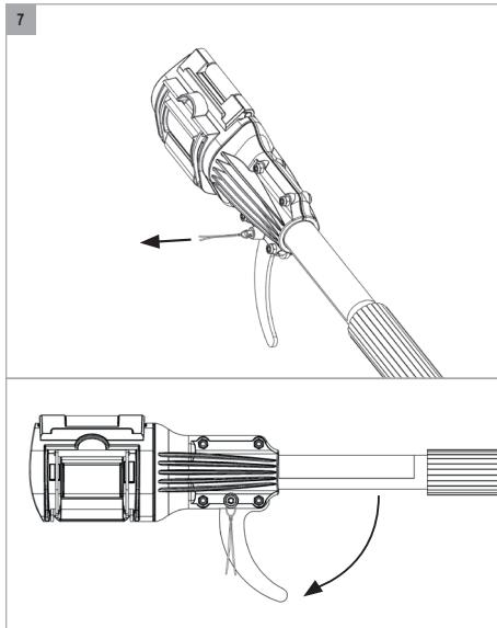
7. Um einen Ast zu erfassen, der nach dem Schnitt nicht zu Boden gefallen ist, können Sie den zu diesem Zweck vorgesehenen Räumhaken (10) verwenden.
