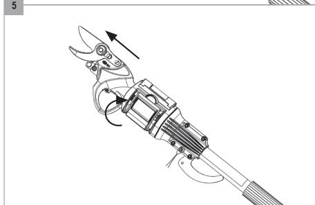
5. Befestigen Sie den Verschlusshebel des Befestigungssystems (8) an der gegenüberliegenden Seite. Verschließen Sie das Befestigungssystem, indem Sie die beiden Hälften gegeneinander verriegeln. Versichern Sie sich, dass der Verschlusshebel des Befestigungssystems (8) richtig verriegelt ist. Beim Gebrauch der Verlängerungsstange darf sich kein Teil des Verschlusshebels des Befestigungshebels (8) frei bewegen.
