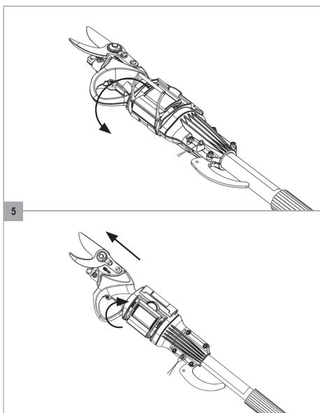
5. 고정 장치 래치 레버(8)를 반대편 덮개에 고정되도록 닫습니다. 덮개와 맞물리도록 고정 장치를 잡깁니다. 고정 장치 래치 레버(8)가 제대로 잡겨 있는지 확인하십시오. 연장 막대가 사용 중일 때 고정 장치 래치 레버(8)의 그 어떤 부품도 움직여서는 안 됩니다.
