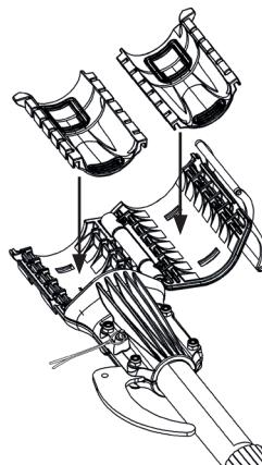
B. Segure nos novos encaixes (11) e fixe-os nas duas partes do sistema de fixação da ferramenta (1) orientando-os corretamente.
